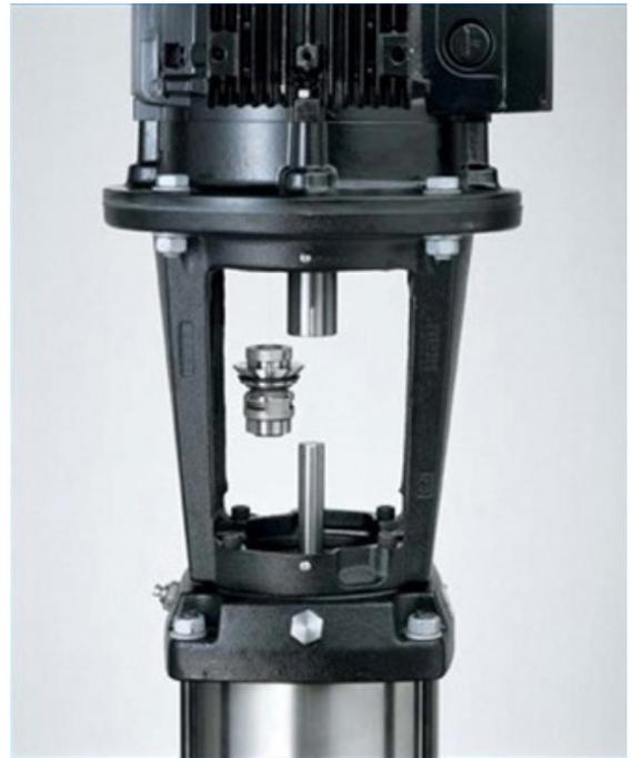
图 2：便于作业的一体式筒式机械轴封只需数分钟即可完成更换，且无需拆卸电机。这避免了在更换长耦合端吸泵和中开泵的密封后重新校准电机和轴所需的时间和精力。
