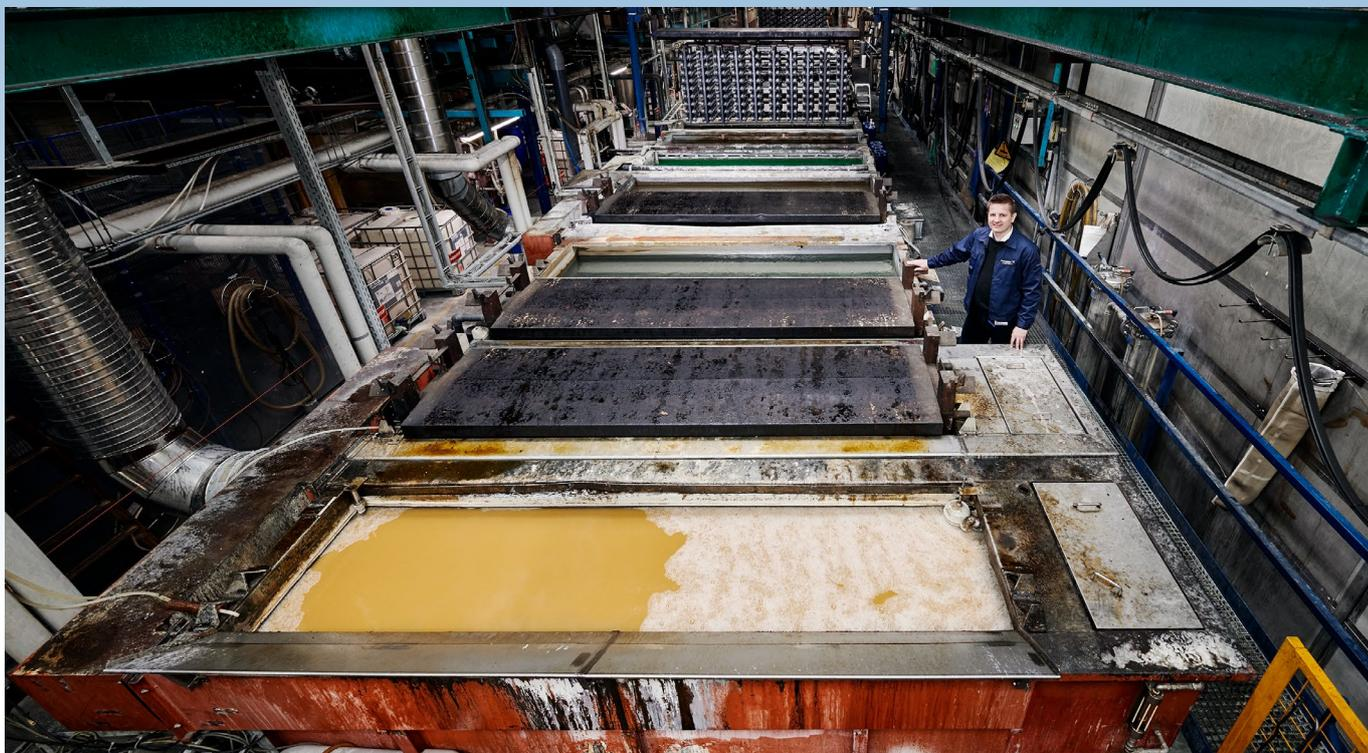
丹麦格兰富公司的高级制造主管Anders Lund Hansen展示了CED表面处理的应用。这是一系列浴槽，里面是化学物质、水和涂料，可最终保护水泵部件免受磨损和生锈。格兰富过去只是简单的达标排放使用过的冲洗水——每年 5000立方米。现在它会对这些废水进行处理并重复利用。
