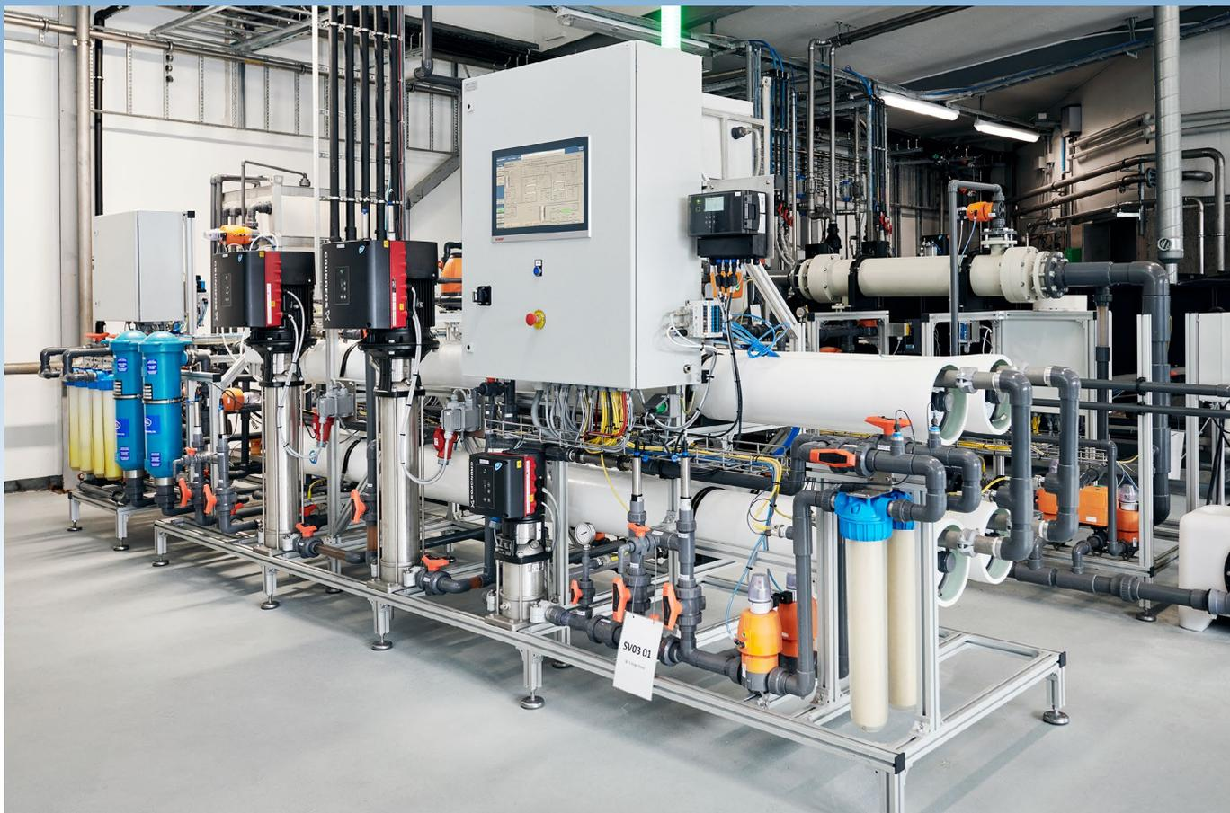
该系统采用一系列过滤器和反渗透技术处理格兰富 CED表面处理用过的废水。然后，将干净的水送回CED单元重新使用。
