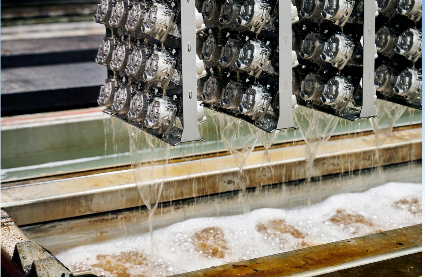
在边昂布的格兰富工厂，挂满新压铸部件的机架从CED表面处理系统中的第一个冲洗池中升起。
