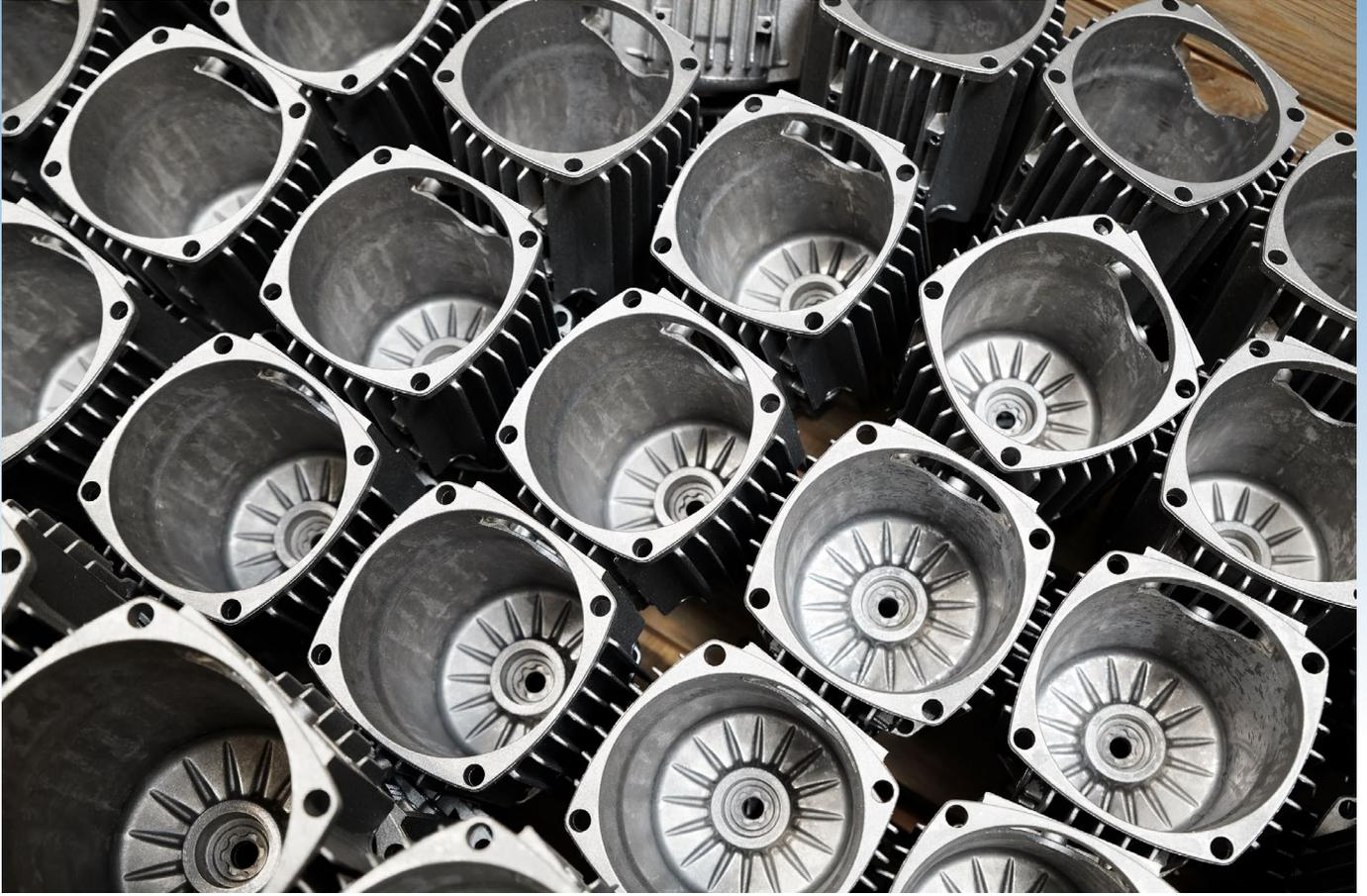
新的压铸部件将很快通过格兰富CED表面处理系统进行处理。
